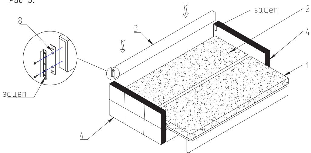
1. Для корректного раскладывания дивана следует отрегулировать зазор между сиденьем и откидной спинкой дивана в разложенном виде. Регулировка производится с помощью изменения положения сиденья относительно замков дивана. Ослабив крепежные болты и сдвигая сиденье вперед/назад относительно замков – добиться желаемого зазора. Затянуть болты. (См. Узел В).
